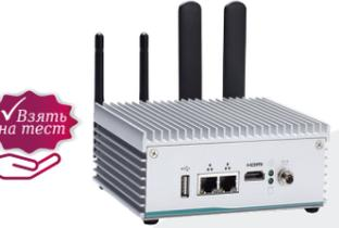
**Компактный промышленный компьютер** на базе NVIDIA® JETSON™ TX2 / Pascal™ GPU
